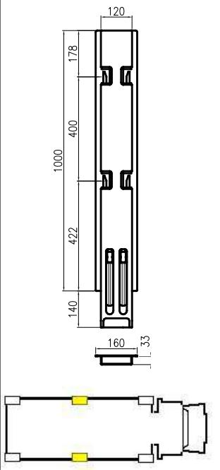
Montanti rovesciabili con battuta di 33 mm per sponde in alluminio
