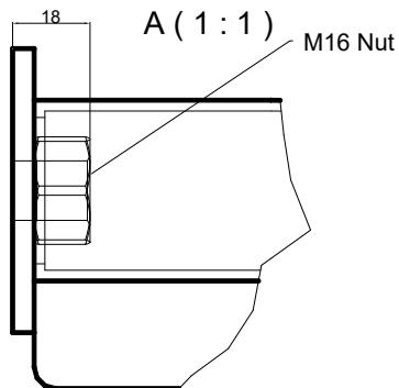
Tubo di fissaggio con dado M16 Ø42
