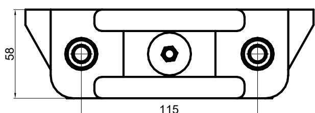
Supporti Ø45 per cilindri, forniti di relativa bulloneria
