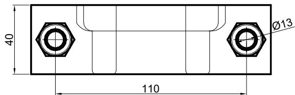
Supporti Ø50 per cilindri, forniti di relativa bulloneria
