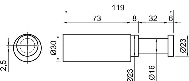
Perno eccentrico per testata ( $\varnothing 23$  L=5 mm) zincato
