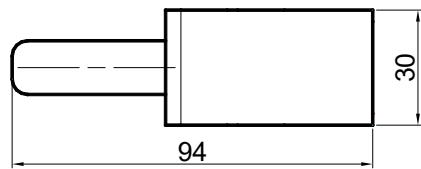
Cerniera bombata tipo "riven" Ø15
