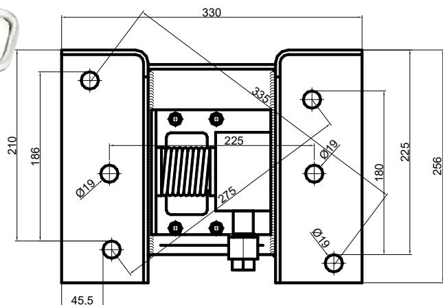
Porta ruota laterale per mozzi con interasse da 150 a 220 mm completo di maniglia
