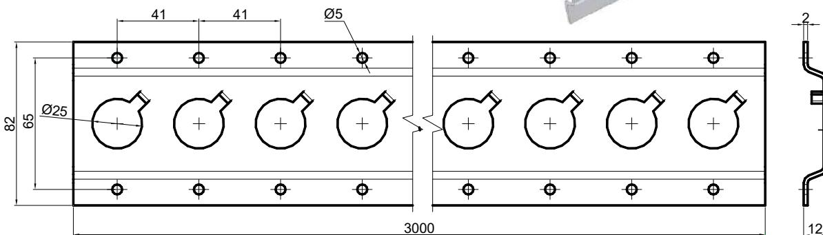
Barra in alluminio con perni e protezione in pvc
