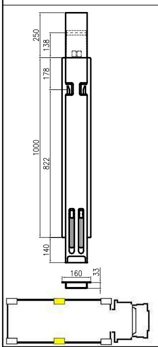
Montanti rovesciabili con battuta di 33 mm per sponde in alluminio
