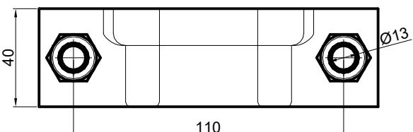
Supporti Ø55 per cilindri, forniti di relativa bulloneria
