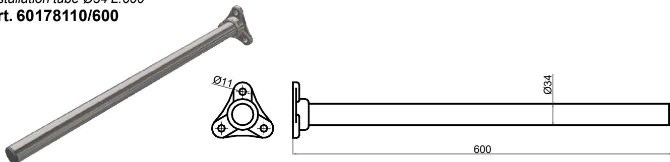
Tubo di fissaggio Ø 34
