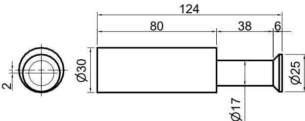
Perno eccentrico per testata ( $\varnothing 23$  L=8 mm) zincato
