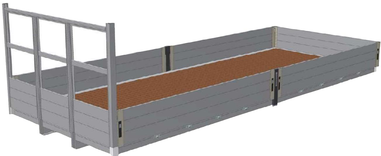
Il Pianale in alluminio con pavimento multistrato plywood
