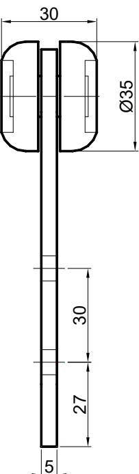
Carrelli per teloni montati su biglie e ruote in nylon Ø35
