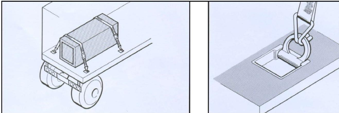
Cinghia con tensore e bloccaggio con ganci in trafiletto
