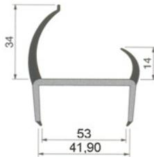
Profili per porte realizzati in PVC gomma. Hanno la particolarità di mantenere la propria elasticità anche alle basse temperature. Indicati per veicoli frigo. I profili sono coestrusi quindi la parte rigida permette un notevole risparmio di tempo sia nel taglio che nel montaggio. I profili angolari sono realizzati in PVC antiurto.
